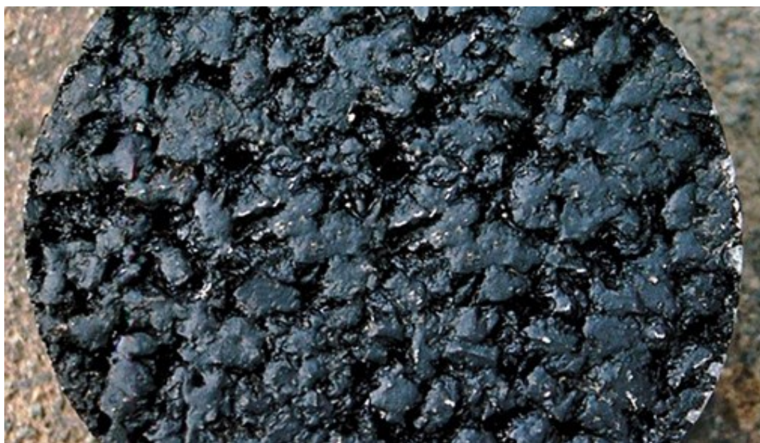
Рис. 3. Структура керна ЩМА
