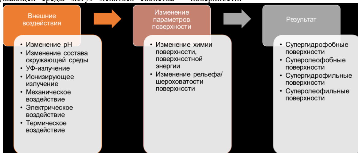
Рис. 4. Изменение параметров поверхности материала за счет воздействия внешних факторов
